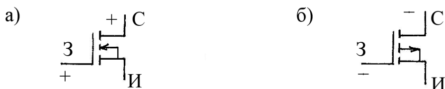
Рис. 6.7. Условные обозначения полевых транзисторов с инверсным каналом и внутренним соединением подложки и истока: а – n-канальных, б – p-канальных
